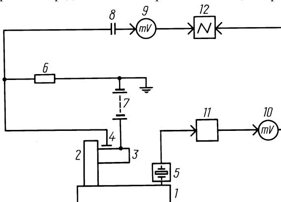
1 — стол вибростендса; 2 — приспособление для испытаний; 3 — испытуемое изделие; 4 — искусственный электрод; 5 — пьезоэлектрический вибропреобразователь; 6 — резистор с номинальным сопротивлением 2—5 МОм; 7 — батарея элементов; 8 — конденсатор; 9, 10 — милливольтметры; 11 — катодный повторитель; 12 — осциллограф
