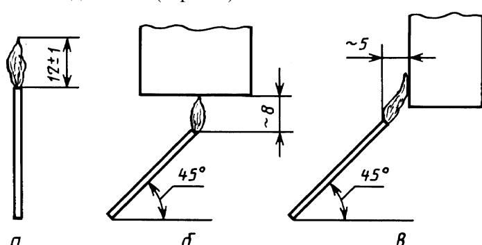
Положение газовой горелки; *a* — при установке высоты пламени; *b*, *c* — во время испытания изделия
