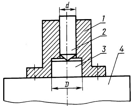
1 — корпус крещерного устройства; 2 — инерционный элемент; 3 — крещер; 4 — стол испытательного стенд
