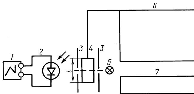
1 — осциллограф; 2 — фотодиод; 3 — диафрагма; 4 — мерная база; 5 — источник света; 6 — стол стенд; 7 — наковальня
