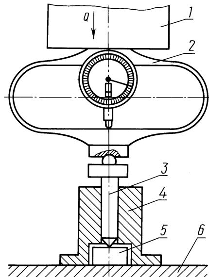
1 — поршень пресса; 2 — динамометр; 3 — инерционное тело; 4 — крещерное устройство; 5 — крещер; 6 — стол пресса
