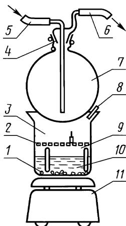
1 — противотурбулентные камни; 2 — опора для изделий; 3 — место для размещения изделий (высота около 75 мм, диаметр около 125 мм); 4 — зажимное приспособление для поддержки колбы; 5 — пуск охлаждающей воды; 6 — выход охлаждающей воды; 7 — двухлитровая колба из боросиликатного стекла; 8 — неплотно закрытый носик химического стакана; 9 — двухлитровый химический стакан из боросиликатного стекла; 10 — деионизованной воды 800 см<sup>3</sup>; 11 — нагревательная плита
